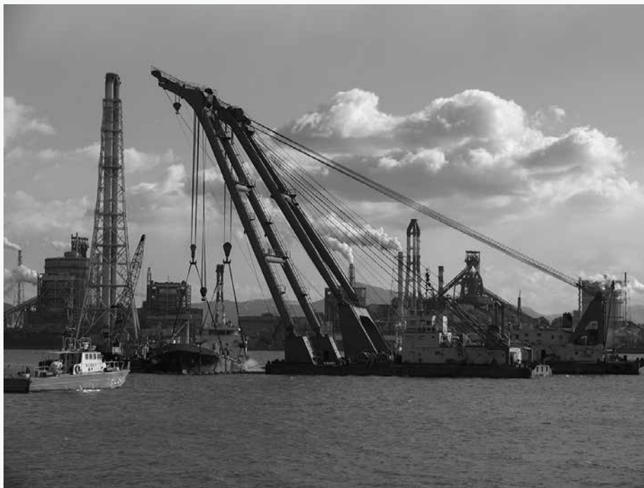
ジブ式起重機船「不退転(150t吊)」、「白虎(265t)」サルベージ作業
