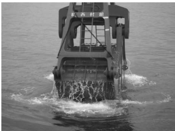
密閉式バケット特殊蓋構造 (株)光栄鉄工所 特許第3884008号)
