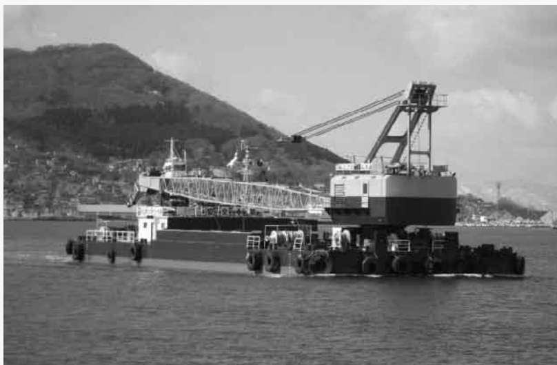
第62幸丸(非自航旋回式起重機船 160t吊)
