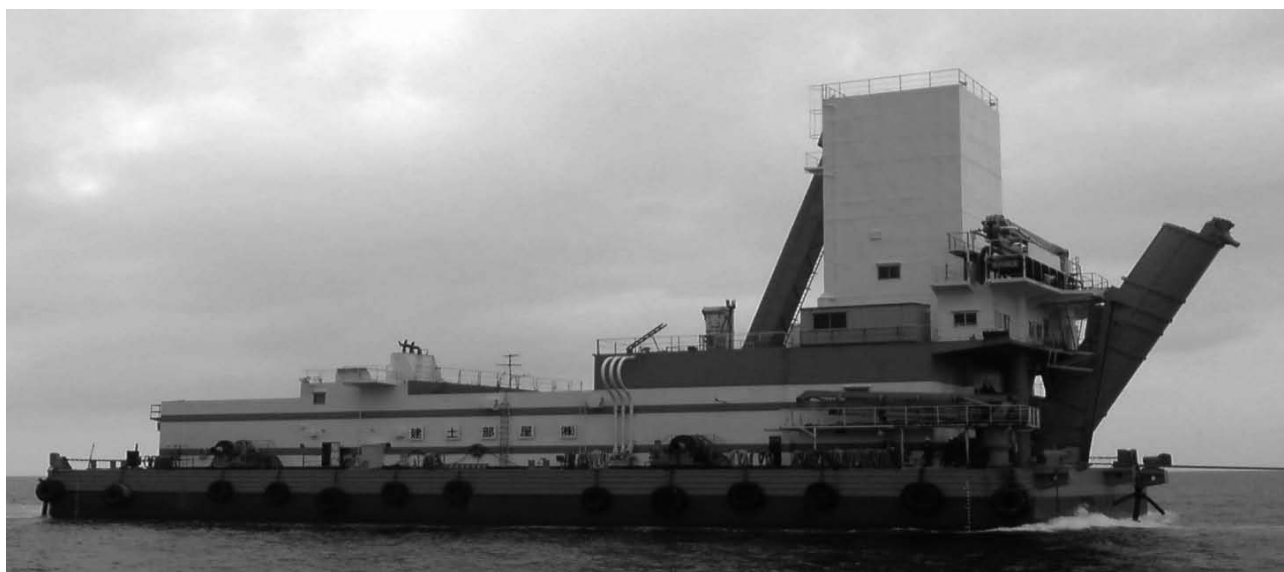
コンクリートプラント船 久護-850
