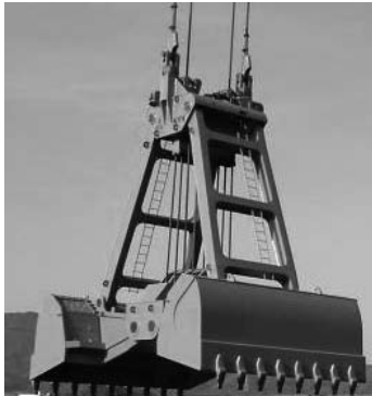
写真-3 軟泥地盤用グラブバケット
