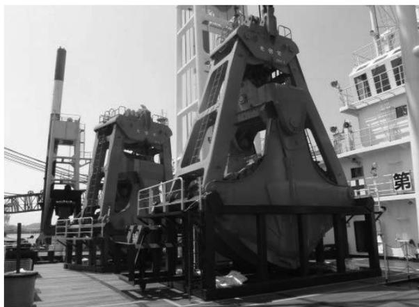
写真-3 グラブバケット軟土盤用 30m<sup>3</sup>
