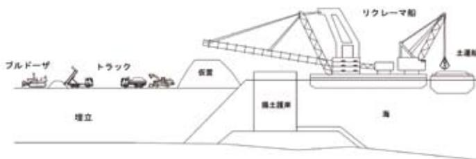
図4 埋立工事の施工イメージ
