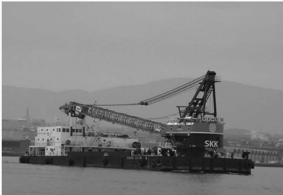
起重機船(300t吊)第三十五北日本号
