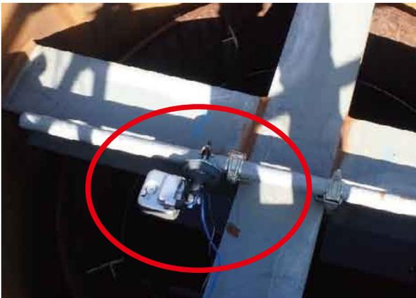
写真-6 ジャケット内のCCDカメラ
