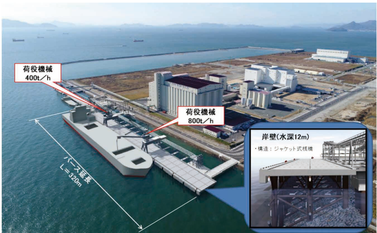
図-12:岸壁完成図(イメージ)
