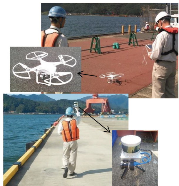
図-5 点群データ及びドローン写真測量
