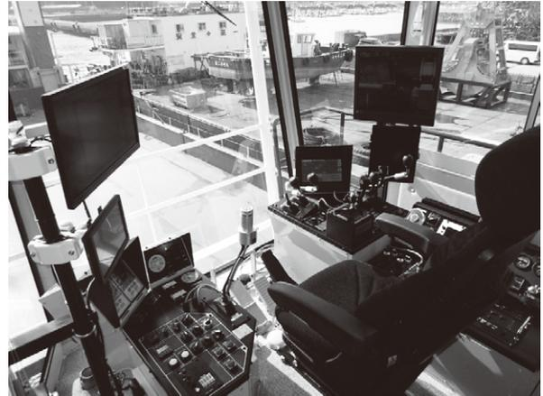
写真-4 クレーン操作室操作盤
