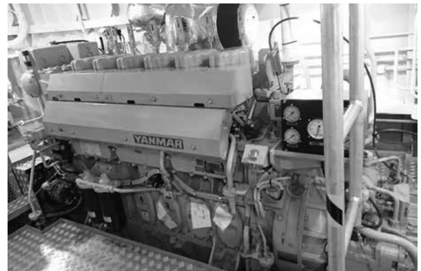
写真-11 押船第75幸丸エンジン(ヤンマー6EY17W)
