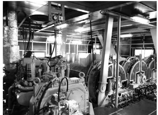
写真-12 クレーンエンジン(三菱S6M3F-T2MTKL)
