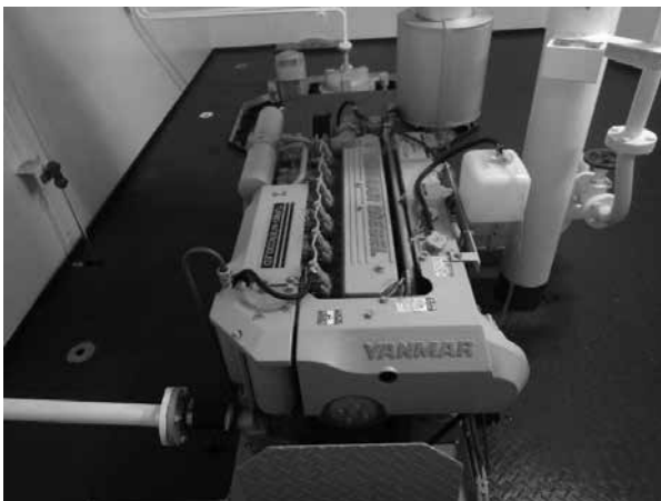
写真-10 スラスタエンジン(ヤンマー6LY2-WST)
