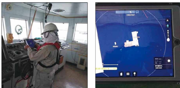
海上作業船内での航行支援システム利用状況 航行支援システムでの他作業船位置情報画面
