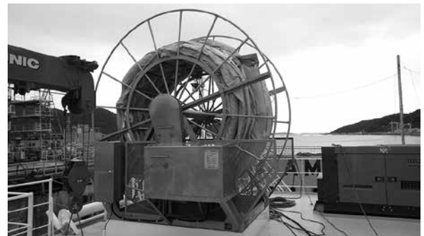
写真-8 オイルフェンス巻取機
