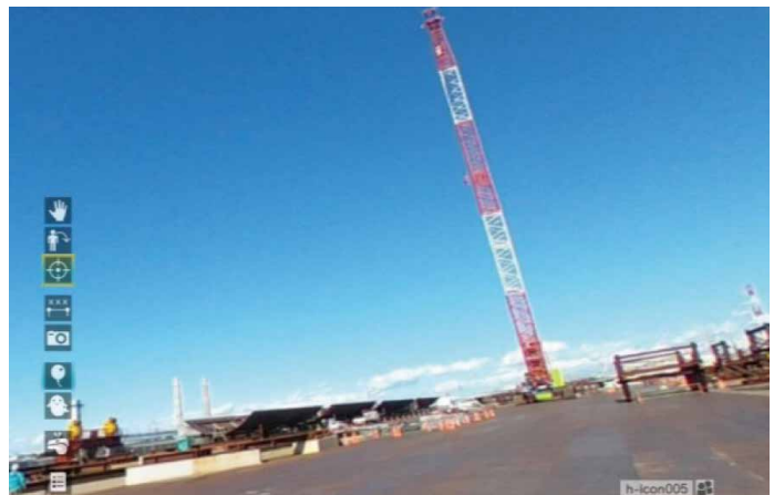
図-17 VR仮想モデルと360度カメラ 画像のリンク
