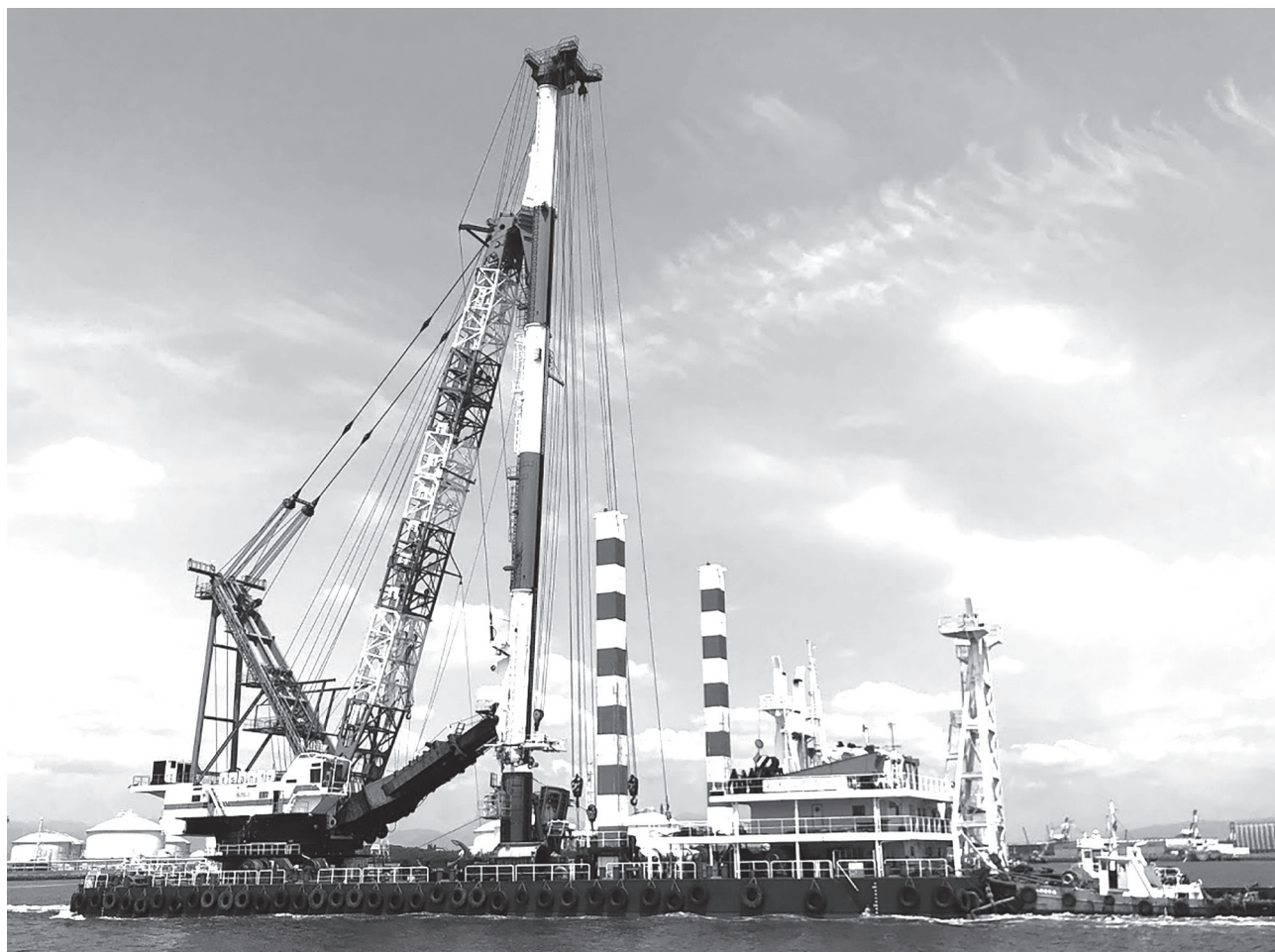
第十八御在所号（杭打船兼起重機船）全景
