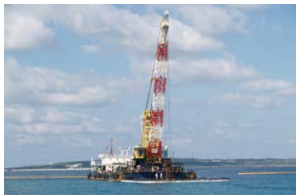
起重機船兼浚渫船 大米2号
