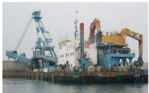
苅田港で航路浚渫土を揚土中の「オーシャン1号」
