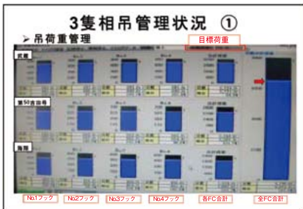
荷重管理モニター画面表示状況
