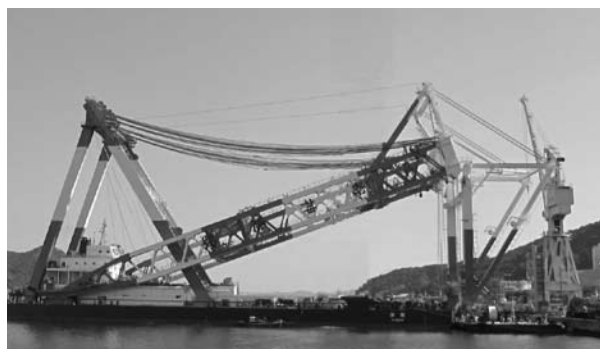
写真-2 「洋翔」ジブ格納状態
